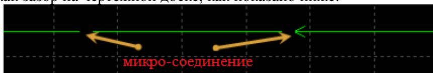
Чтобы добавить микро-соединение, нажмите на кнопку «
