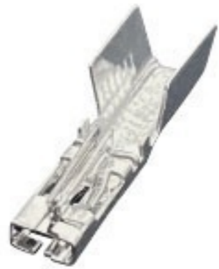
Type: TSH630 Материал: Сплав медно-фосфористый лужёный Применимая толщина: 0.5
