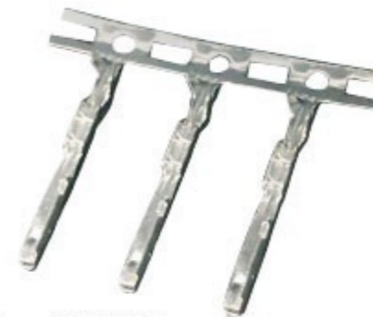
Type: TSH600 Материал: Сплав медно-фосфористый лужёный Применимая толщина: 0.4
